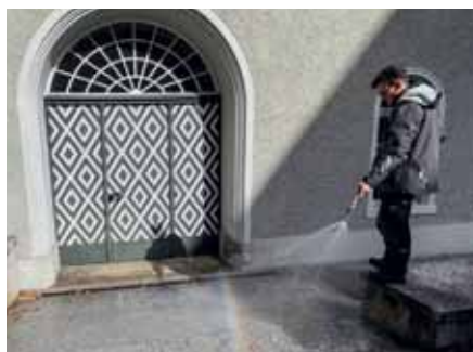
Bild 4: Beregnungsversuche deuten auf konstruktive Schwachstellen hin.
