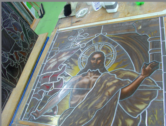
Fertig gebleites Feld, vor dem löten
