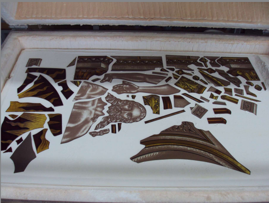
Bis die Glasstücke fertig sind werden teilweise mehrere Brände benötigt
