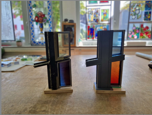
Links alte Fensterkonstruktion Rechts neue Fensterkonstruktion
